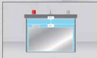
diseño con electrodos dispuestos más abajo y, por tanto, con mayor cabida para el ácido
